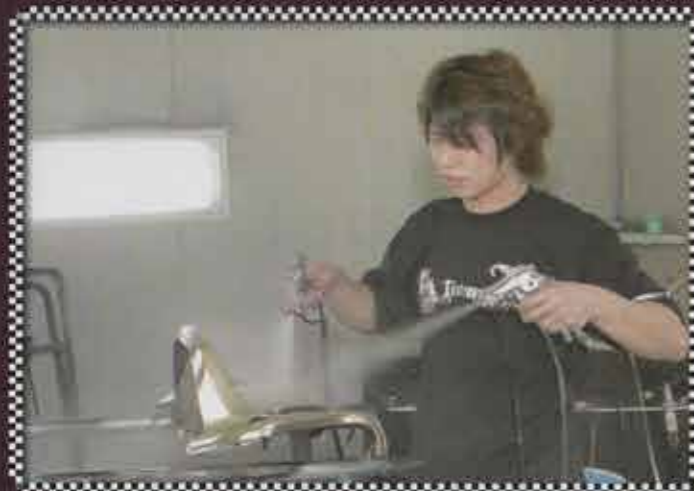
7. 銀の吹き付けと水洗いを、銀鏡がきれいになるまで繰り返す
