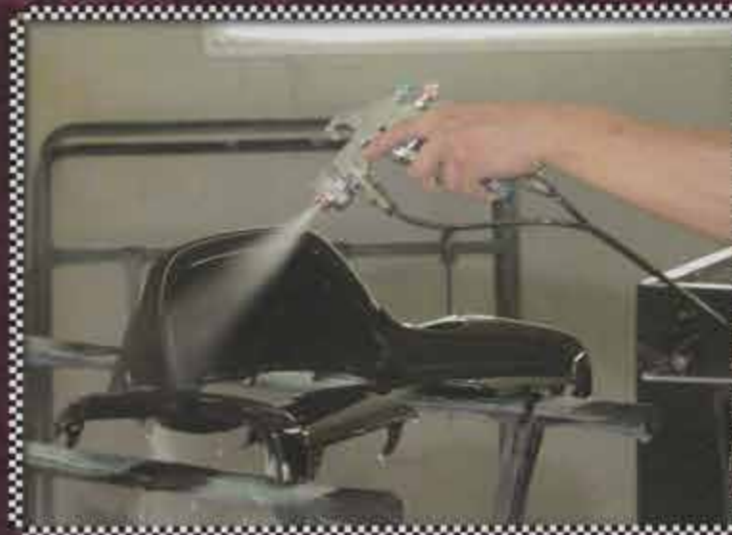
3. 酸性の薬液は、銀と反応し変色させてしまう。そのようなトラブルを防ぐために、ガンのパターンを閉め、純水を勢いよく吹き付けて薬液を十分に洗い流す。また内側に入り込んだ薬液もシミの原因となるので、しっかり洗い流す
