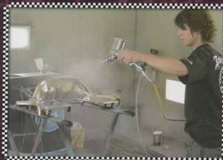
10. 上塗りとしてキャンディーカラーを吹き付け。上に塗った塗料に引っ張られて銀がはがれることを防ぐため、濃いめの塗料を使用し、少ない吹き付け回数で仕上げる
