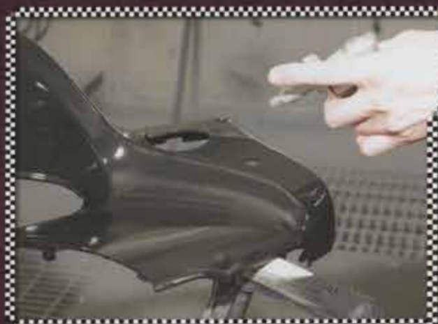
4. 水で十分に洗っても、薬液が膜になって残っているため、エアで飛ばす。その後、再度純水を勢いよく吹き付け、洗い流す
