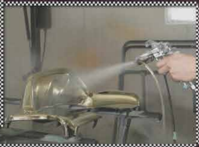
7. 銀の吹き付けと水洗いを、銀鏡がきれいになるまで繰り返す
