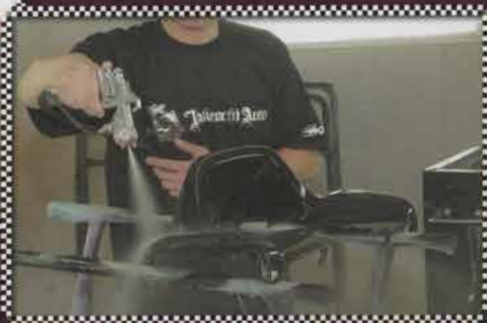
4. 水で十分に洗っても、薬液が膜になって残っているため、エアで飛ばす。その後、再度純水を勢いよく吹き付け、洗い流す
