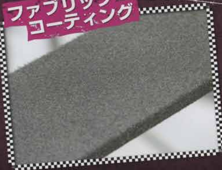
1. 黒でコーティングした木質ボード (MDF) にファブリックコーティングを行う。600番のペーパーで足付けた後、脱脂
