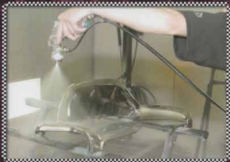
6. 銀の水溶液を吹き付けたら、すぐに純水で洗い流す
