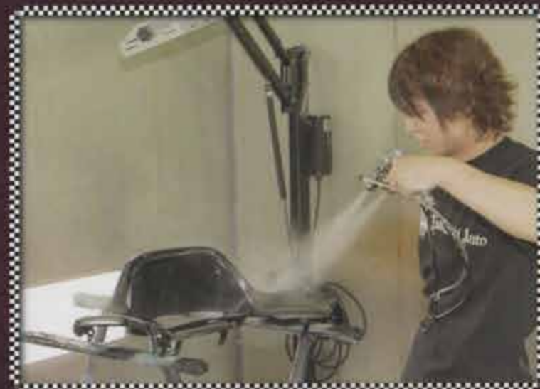
5. 銀の水溶液の吹き付け。全体にまんべんなく、塗料で包み込むよう吹き付ける
