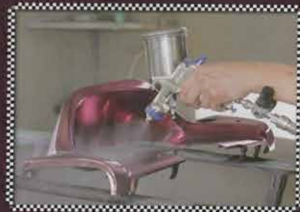
11. 薄く全体に塗膜ができれば、続けてガンを近づけ、しっかりと吹き付ける。その後、さらに濃度を高めたキャンディーカラーの塗料で、2回目の上塗りを実施
