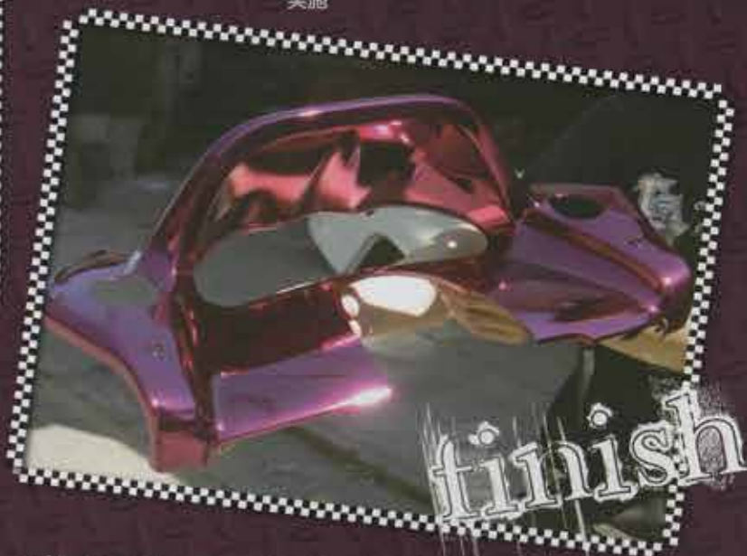
11. 薄く全体に塗膜ができれば、続けてガンを近づけ、しっかりと吹き付ける。その後、さらに濃度を高めたキャンディーカラーの塗料で、2回目の上塗りを実施
