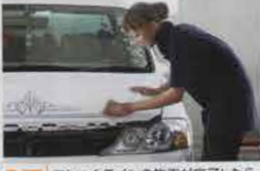
07 フレークラインの施工が完了したら、フレークラインを軽くサンドペーパーで馴染ませておく。
