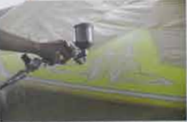
09 貼付ける面に接着剤を吹き付けていく。しばらく待って粘着性が上がってから貼付けていくのがコツなのだ。
