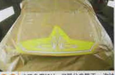
08 さて今度はリーフ部分の施工。次は逆にフレーク部分をマスキングで隠し、リーフを貼付ける面を露出させる。
