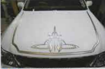
15 スピニングも入れ終わって、後はクリアを全体的に入れてから磨き作業などの仕上げのみだ。
