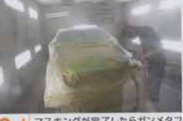
04 マスキングが完了したらガンメタフレークに若干の同系色の塗料を混ぜて色味を強めてから吹き付けていく。
