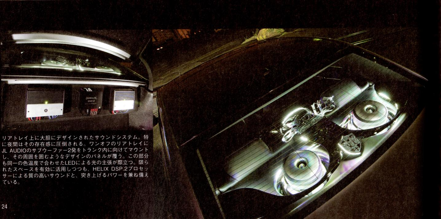
リアトレイ上に大胆にデザインされたサウンドシステム。特に夜間はその存在感に圧倒される。ワンオフのリアトレイにJL AUDIOのサブウーファー2発をトランク内に向けてマウントし、その周囲を包むようなデザインのパネルが覆う。この部分も同一の色温度で合わせたLEDによる光の主張が際立つ。限られたスペースを有効に活用しつつも、HELIX DSP.2プロセッサーによる質の高いサウンドと、突き上げるパワーを兼ね備えている。
